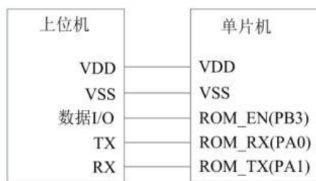
图 6：ISP 下载接口示意图
