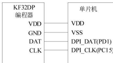
图 7：DPI 下载接口示意图
